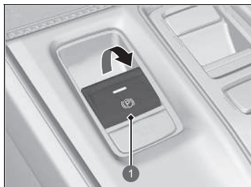
1 Schakelaar van de elektronische parkeerrem
